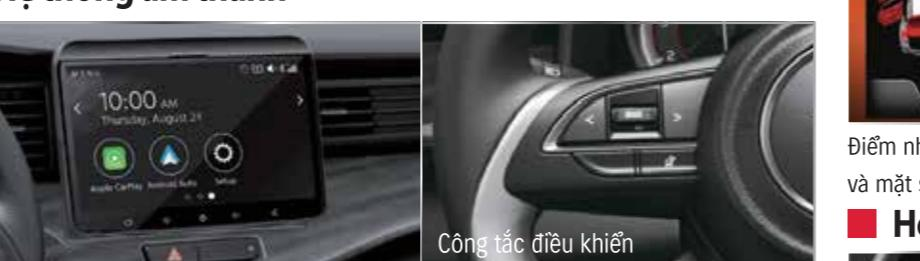
Hệ thống âm thanh được trang bị màn hình cảm ứng 10" hoạt động tương thích với Apple CarPlay và Android Auto. Kết nối USB, AUX, hoặc Bluetooth. Tích hợp camera lùi được đặt ở vị trí cao giúp mở rộng tầm quan sát. Gói điện và truyền âm thanh rảnh tay thông qua Bluetooth.
